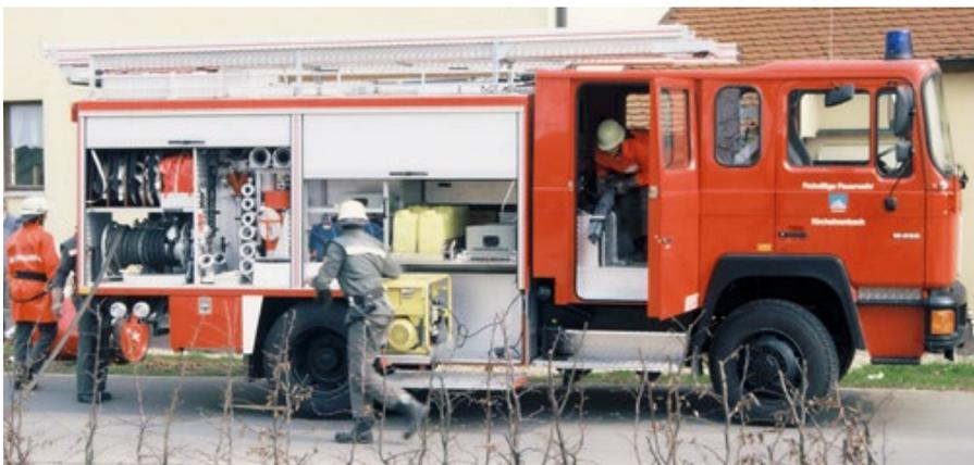
Das neue Löschgruppenfahrzeug LF 16/12 trifft ein. Es ist mit einem 1.200-Liter-Wassertank, hydraulischer Schere und Spreizer sowie Hebekissen ausgestattet und kostet rund 420.000 DM. Bei der Weihe am 4./5. Juli wird der Einsatz mit dem neuen Fahrzeug in einer Schauübung demonstriert (Bild von 1993, siehe unten).
