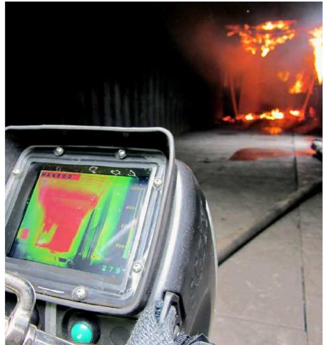
Entwicklung und Hitzeverteilung sind auf dem Display der Wärmebildkamera genau zu erkennen. Fotos: smü
