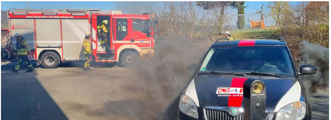
„Worst Case“: Die Batterie zündet durch, der sogenannte „Thermal runaway“.
