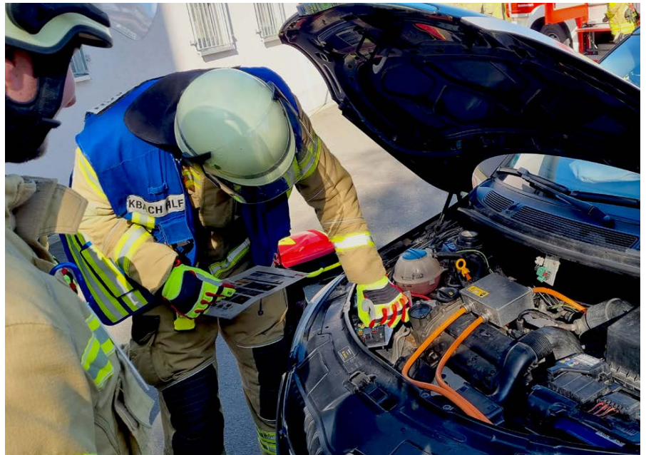
Per Rettungsdatenblatt mussten die Trennstellen für das Hochvoltsystem gefunden werden. Das Schulungsfahrzeug bot dazu viele auf dem Markt gängige Lösungsmöglichkeiten.
